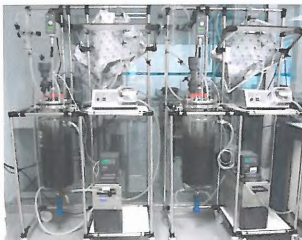
Figura 2.1. Equipo de co-digestión en continuo.
