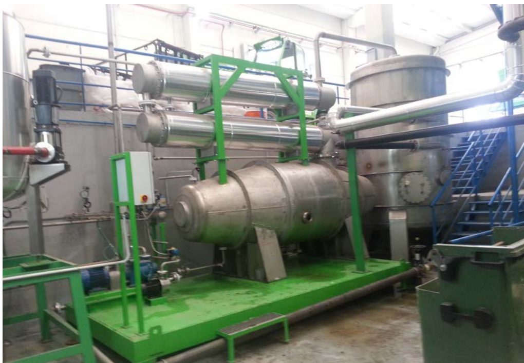
Figura 25: Sistema de captación de vapor de la planta
