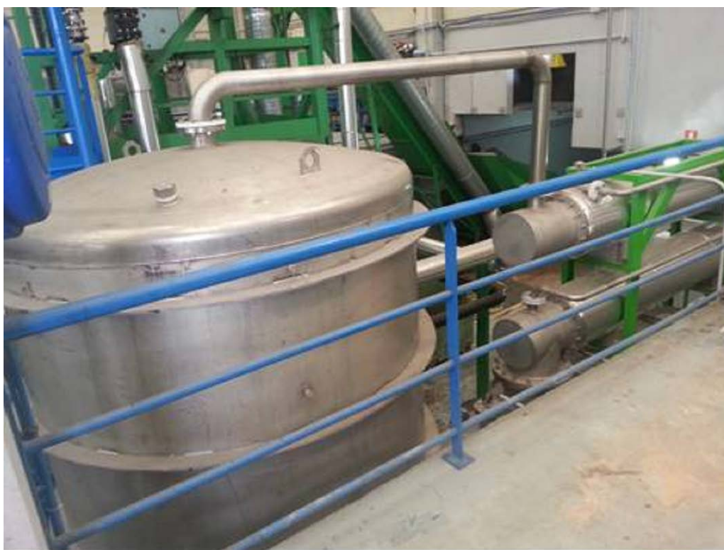
Figura 26: Detalle del depósito del sistema de captación de vapor
