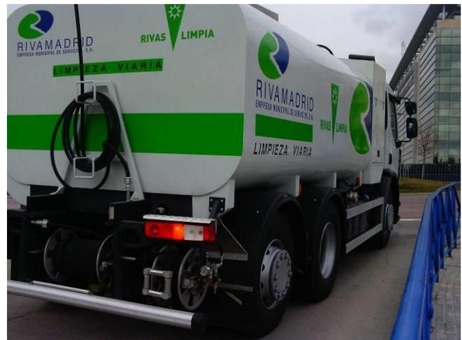
pavimento efectúan una acción de limpieza arrastrando los residuos y pequeñas partículas hasta el bordillo y a través del mismo hacia los imbornales. Para la realización de este tratamiento se utiliza agua no potable, procedente de pozos o lluvia y es realizado por un conductor.
